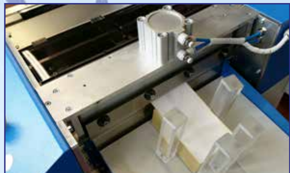
Gruppo taglio orizzontale con cilindro pneumatico Horizontal cutting unit with pneumatic
